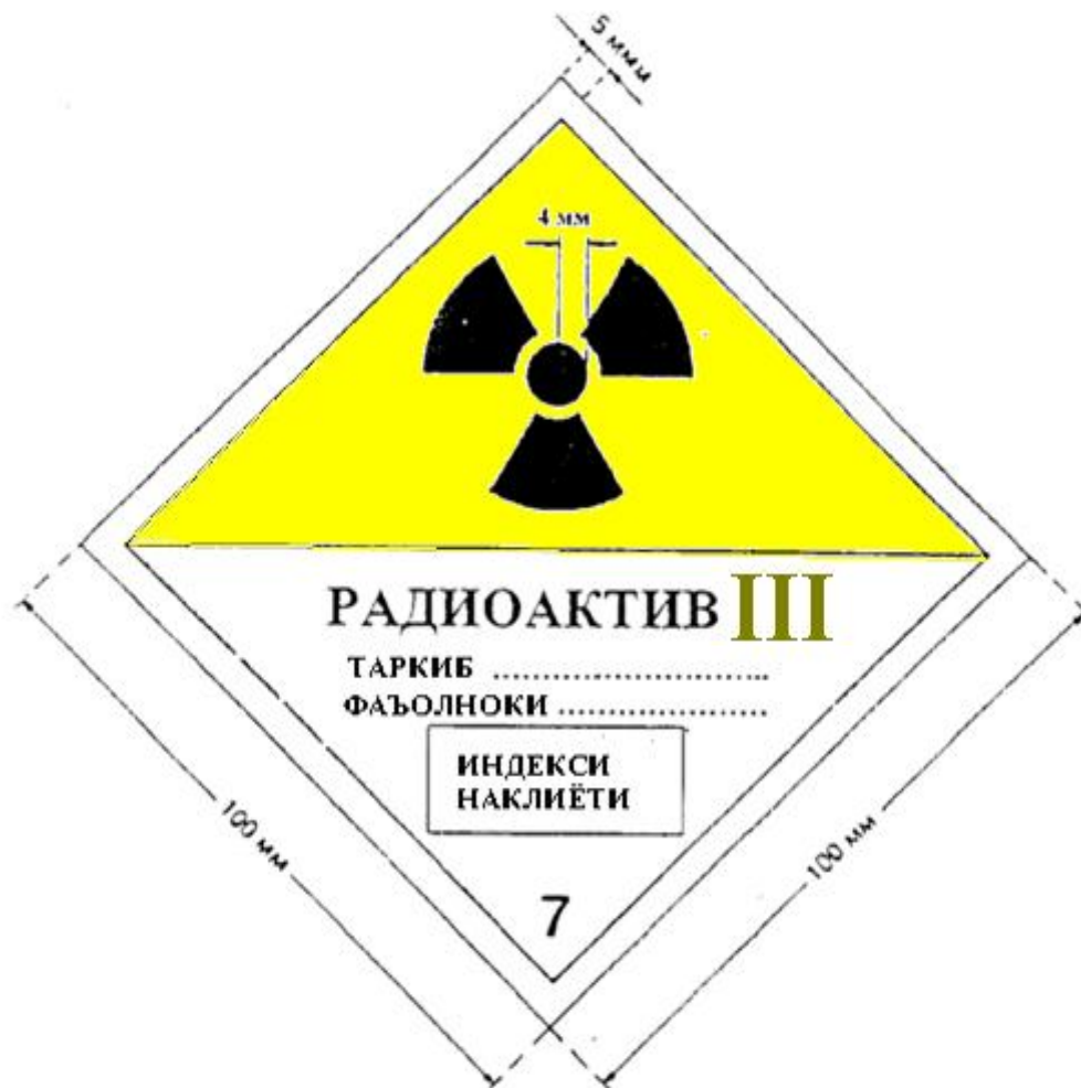
Рис.4. Тамгаи дараҷаи "III-ЗАРД". Ранги манзараи болои нисфи тамга - зард, нисфи поёнӣ – сафед, ранги нишони асосии хатари радиатсионӣ (себарга) ва навиштаҷотҳо - сиёҳ, ранги хате, ки дараҷаро нишон медиҳад – сурх.
